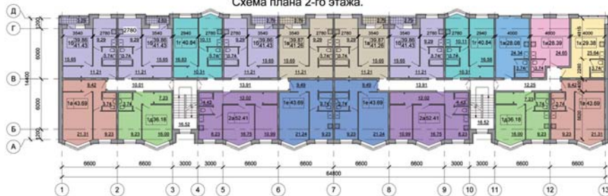
Многokвартирный 2-х секционный 3-х этажный жилой дом. Схема плана 2-го этажа.
